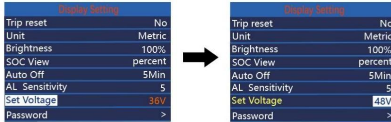
interface de réglage de la tension de la batterie
